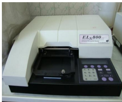
صورة رقم (25) تظهر الجهاز القارئ لـ Reader الـ ELX800 u.v. Biotek طراز العالمية
